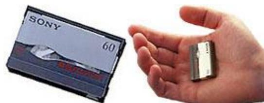
Avec une taille 70% plus petite que la cassette DV, la cassette Micro MV a permis la création de caméscopes ultra-miniaturisés. La vidéo y est enregistrée en MPEG2, un format facilement exploitable sur PC.
