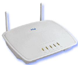
Le **W.L.L** (Wireless Local Loop) est un des technologies des plus prometteuses actuellement. Elle se base sur le principe que l'utilisateur n'aie plus besoin de se connecter physique à la prise murale pour surfer sur le web. On utilise pour cela les ondes électromagnétiques similairement au Natel.
