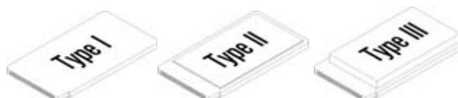
Le PCMCIA de type IV (non présenté ci-dessus et toujours dans les tiroirs des fabricants depuis 1996) permettrait d'insérer des cartes d'une épaisseur supérieure à 10.5 mm.
