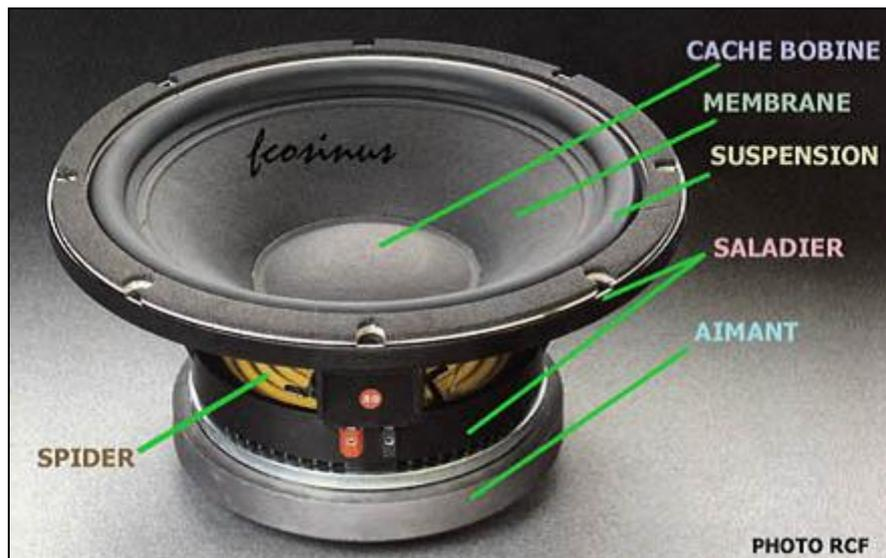
La reproduction des graves demande un déplacement d'air important c'est la raison pour laquelle la membrane doit être mobile et de taille importante.
