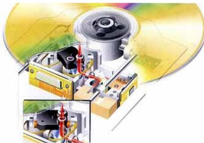
Mécanique de lecture à double système optique utilisée sur certains lecteurs de DVD, mais d'autres modèles utilisent un seul bloc optique avec système de focalisation variable.
