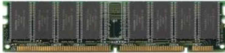
Utilisées initialement avec les Pentium on en trouve deux formats, 144 et 168 broches. Un module DIMM correspond à deux modules SIMM.
