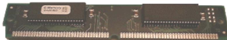
Les Pentium (processeurs 32 bits) lisent les informations grâce à des adresses 64 bits. Il faut donc les coupler afin que l'ordinateur compose ses adresses à la taille convenable. Les mémoires EDO et FPM sont de type SIMM.
