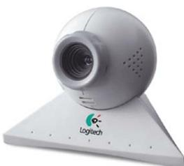
Une webcam est une petite caméra reliée à votre ordinateur. Elle est composée de milliers de capteurs (CCD) qui transforment l'image en la numérisant. L'image de départ devient alors une image numérique.
