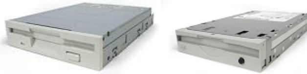
Les lecteurs de disquettes 3"1/2 ou Zip fonctionnent sur le même principe qu'un disque dur excepté que les disques sont parfois "mous".
